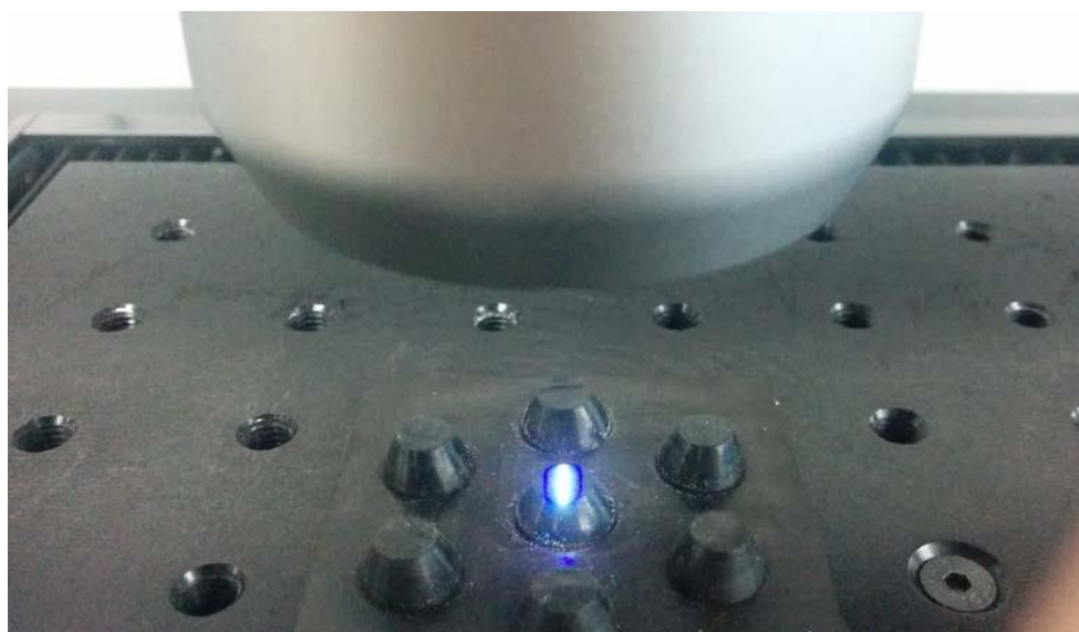
図1: 光学ラインセンサーによるゴム表面測定
