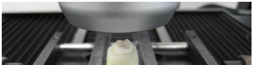
歯のサンプルとプロファイラー光学系
